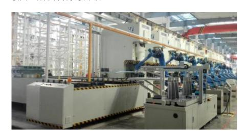
模具立体库自动换模系统结合了自动换模技术、立体库技术和信息化技术,该系统主要集成设备有换模车、模具转运台车、旋转台车、推拉机构、过渡台、压机过渡架组件、锁夹模系统、模具立体库及重型堆垛机等。该系统可以完成行业注塑模及冲压模等模具的存放、调度和自动更换,可以根据产品定义相关模具跟换配方从而实现一键快速换模功能,解决模具存放与跟换难,耗时长,换模困难、效率低等问题,减轻工人劳动强度,提高生产效率。
