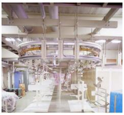
物流悬挂输送系统是高速悬挂输送线与信息化结合的智能配送系统,目前北洋天青主要推动的是一种新型的摩擦杆驱动悬挂输送设备,适合家电业的高速悬挂输送集成应用系统能够解决家电业组装零部件物流搬运困难问题。该系统结合信息化技术,做到物料的分类寄存;自动匹配主线产品调度对应物料,做到智能化调度匹配生产。该系统的应用能够实现智能化互联工厂并解决传统货架或工装车寄存物料导致寄存调度困难、搬运及线边存放混乱、组装寻找匹配困难等问题,从而提高现场生产效率、改善企业生产环境。
