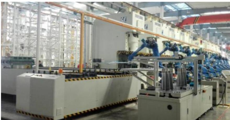
模具立体库自动换模系统结合了自动换模技术、立体库技术和信息化技术，该系统主要集成设备有换模车、模具转运台车、旋转台车、推拉机构、过渡台、压机过渡架组件、锁夹模系统、模具立体库及重型堆垛机等。该系统可以完成行业注塑模及冲压模等模具的存放、调度和自动更换，可以根据产品定义相关模具跟换配方从而实现一键快速换模功能，解决模具存放与跟换难，耗时长，换模困难、效率低等问题，减轻工人劳动强度，提高生产效率。
