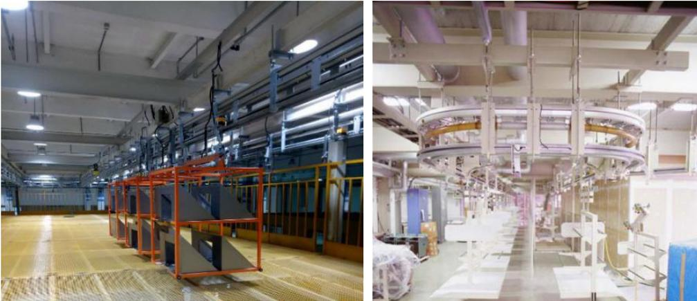
物流悬挂输送系统是高速悬挂输送线与信息化结合的智能配送系统，目前北洋天青主要推动的是一种新型的摩擦杆驱动悬挂输送设备，适合家电业的高速悬挂输送集成应用系统能够解决家电业组装零部件物流搬运困难问题。该系统结合信息化技术，做到物料的分类寄存；自动匹配主线产品调度对应物料，做到智能化调度匹配生产。该系统的应用能够实现智能化互联工厂并解决传统货架或工装车寄存物料导致寄存调度困难、搬运及线边存放混乱、组装寻找匹配困难等问题，从而提高现场生产效率、改善企业生产环境。
